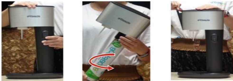
圖 2 安裝二氧化碳鋼瓶並測試是否漏氣
