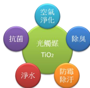
圖五：光觸媒的五大功能
