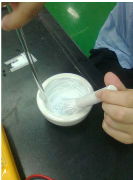
(圖 4：將奈米級二氧化鈦磨成膠狀物)
