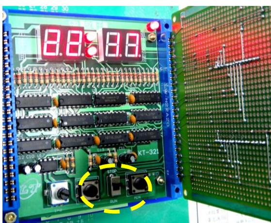
圖八 電子鐘「計時調整模式」測試
