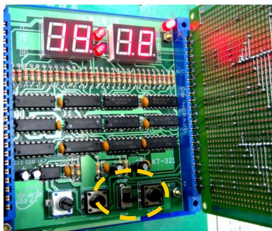
圖九 電子鐘「正常計時模式」測試
