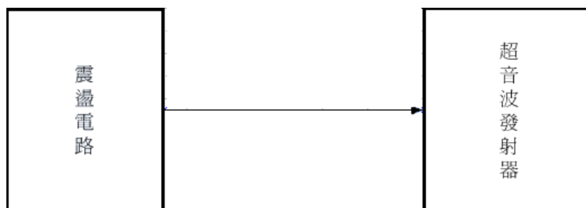
(圖三) 發射電路方塊圖
