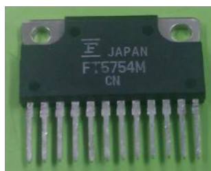
(圖三)達靈頓電晶體 FT5754 元件外觀
