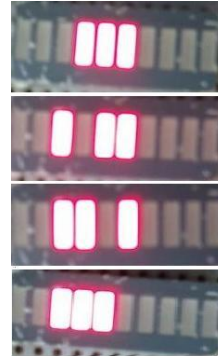
圖26 馬達順時針轉訊號顯示在LED上
