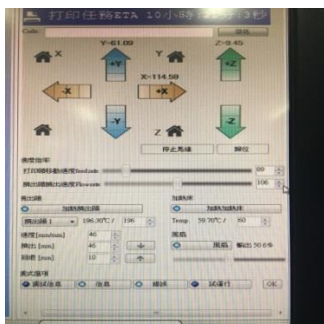
(圖 12) 設定工作溫度和加工程序。
