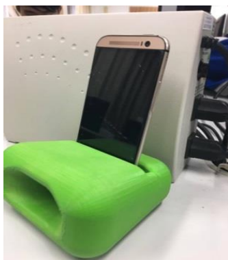
(圖 15)手機擴音功能測試。(圖 16) 手機擴音功能測試。
