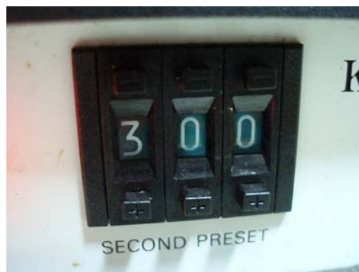
圖十 設定曝光機曝光秒數 (因為是使用普通白紙當曝光底片, 因此曝光時將要將原本透明的120秒提高至300秒。)
