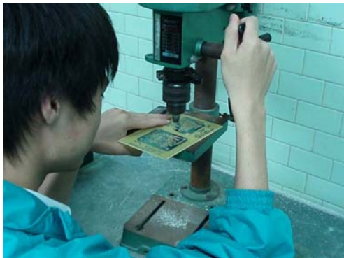
圖十五 使用鑽孔機鑽孔
